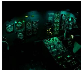
Cobham разрабатывает и поставляет панели и освещение совместимые с ПНВ для новых программ и модернизаций. Наши решения основываются на светодиодах: панели с задней подсветкой, не прямое освещение приборной доски, а также ряд световых источников (стандартных и специальных).
