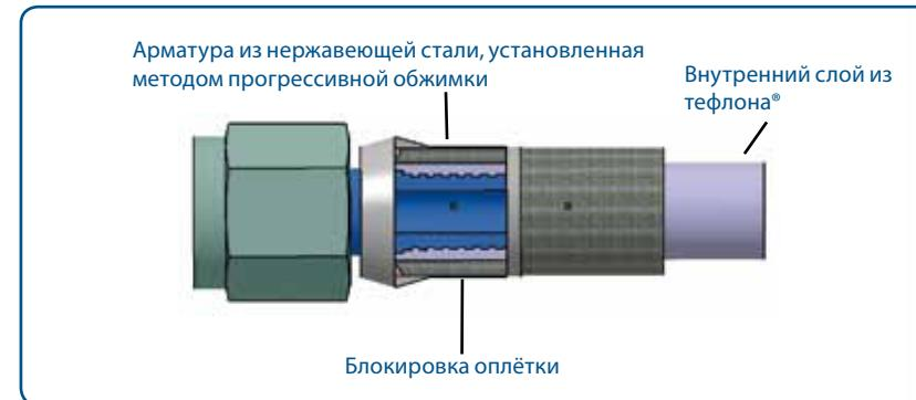
**Присоединительная концевая арматура**: устанавливается методом прогрессивного обжимного соединения. Арматура (втулка, гайка и кольцо) изготавливаются из нержавеющей стали или из алюминия. В каталоге дана информация о самых распространенных видах арматуры, Titeflex также специализируется на разработке арматуры по техническим условиям заказчика.
