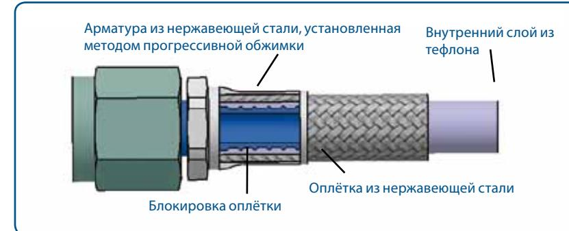
втулка и гайка, кольцо из нержавеющей стали) и алюминиевая арматура. По данной линейке необходимо различать артикулы от -21/2 до -5 (втулка и кольцо из нержавеющей стали, гайка из алюминия) и от -6 до -24Z (алюминиевые втулка и гайка, кольцо из нержавеющей стали).
